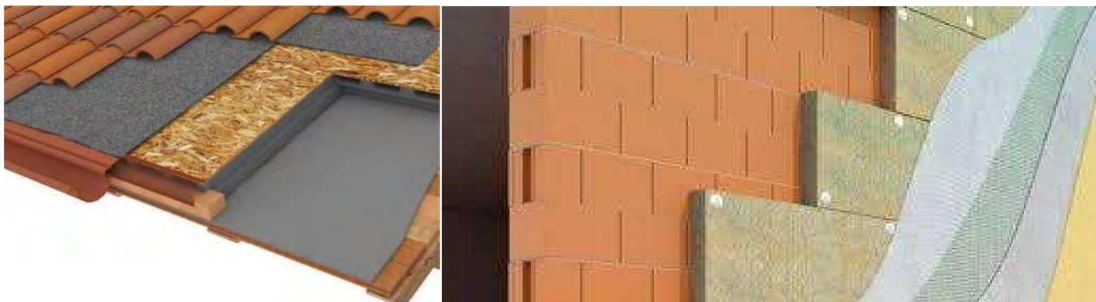
Particolare del tettoventilatoParticolare del tamponamentoesterno
